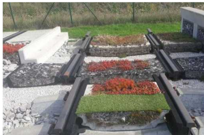
Obr. 3 Pohľady na kryty vozoviek a železničných tratí z recyklovaných materiálov vybudovaných na podkladovej doske STERED® z miešaných odpadov technických textílií s objemovou hmotnosťou 250 kg/m 3
