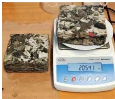
Obr. 6 Pohľady z 9. mája 2022 na skúšobné vzorky podkladovej dosky STERED®, testované v laboratóriu Katedry cestného a environmentálneho inžinierstva Stavebnej fakulty Žilinskej univerzity v Žiline
