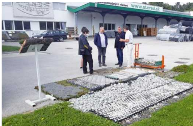
Obr. 3 Pohľady na kryty vozoviek a železničných tratí z recyklovaných materiálov vybudovaných na podkladovej doske STERED® z miešaných odpadov technických textílií s objemovou hmotnosťou 250 kg/m 3
