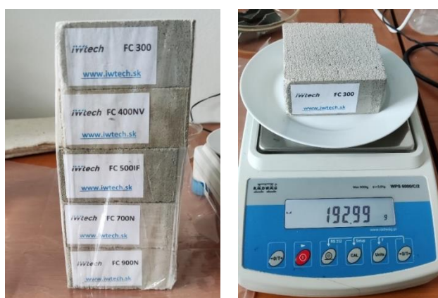
Obr.10: Skúšobné vzorky penobetónu (Foam concrete) vyrobené spoločnosťou IWtech s.r.o.
