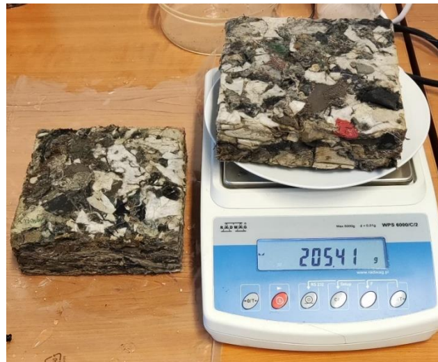
Obr.6: Detailný pohľad na časť STERED ID použitú pre výskum retenčných a evaporačných vlastností [6]
